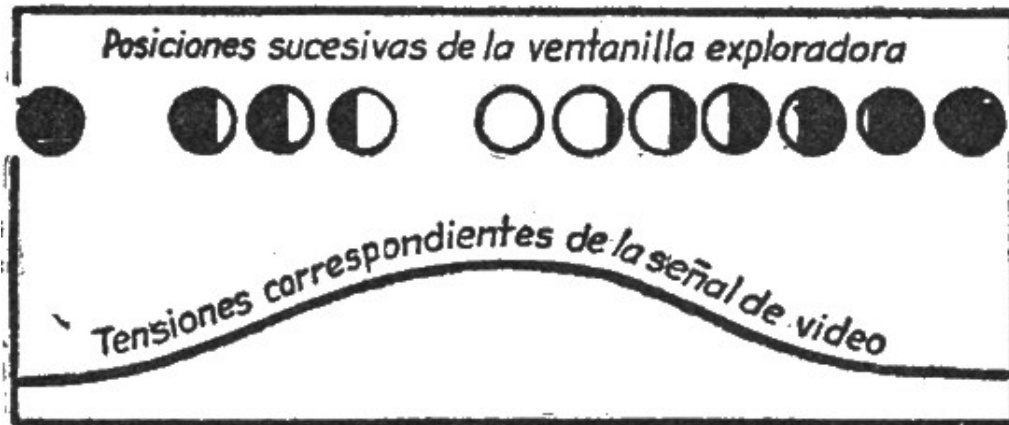
Figura 4. Formación de un ciclo de la señal de video para diversas fases sucesivas de exploración de la imagen.
